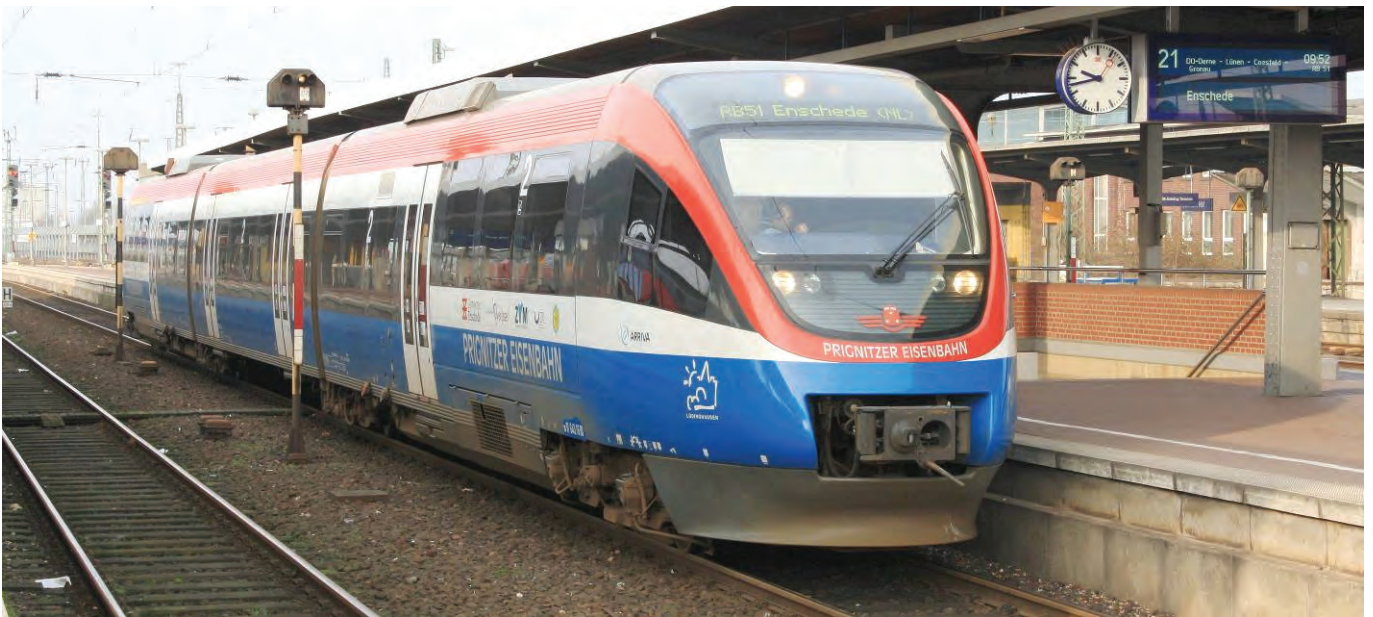
Abb. 42: Ein Dieseltriebwagen des Typs Talent der PEG als RB51 in Dortmund Hbf. In der Hauptverkehrszeit verkehren diese Züge auch in Doppel- und Dreifachtraktion
