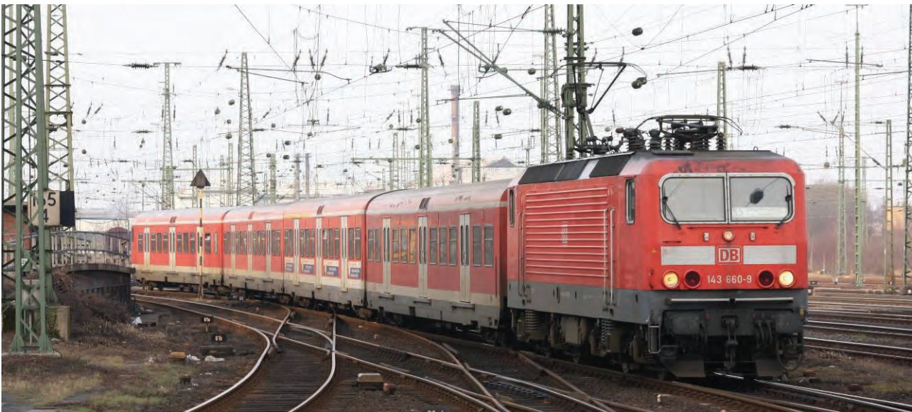
Abb. 15: S-Bahn-Zug gebildet aus x-Wagen sowie Lokomotive der Baureihe 143
